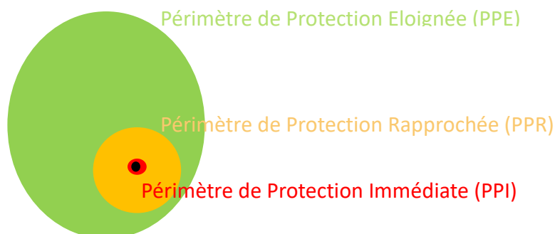
Figure 10: Schéma des périmètres de protection autour d'une source de captage d'eau potable
